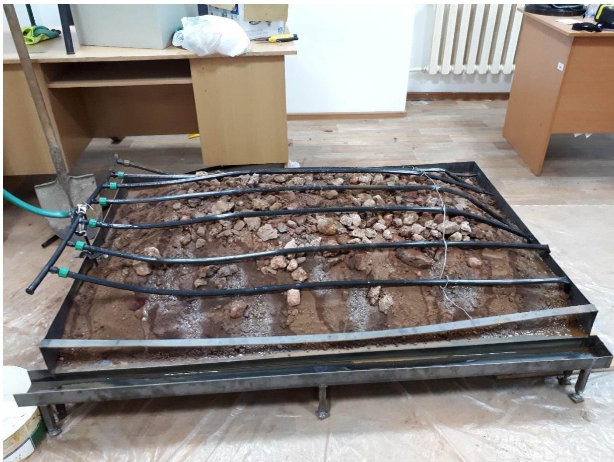
Рисунок 16 - Установка кучного выщелачивания
