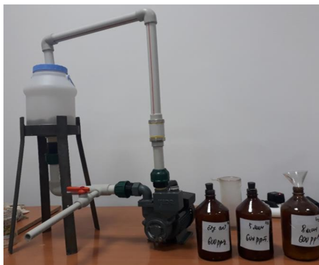
Рисунок 10 - Лабораторная установка для кавитации раствора
